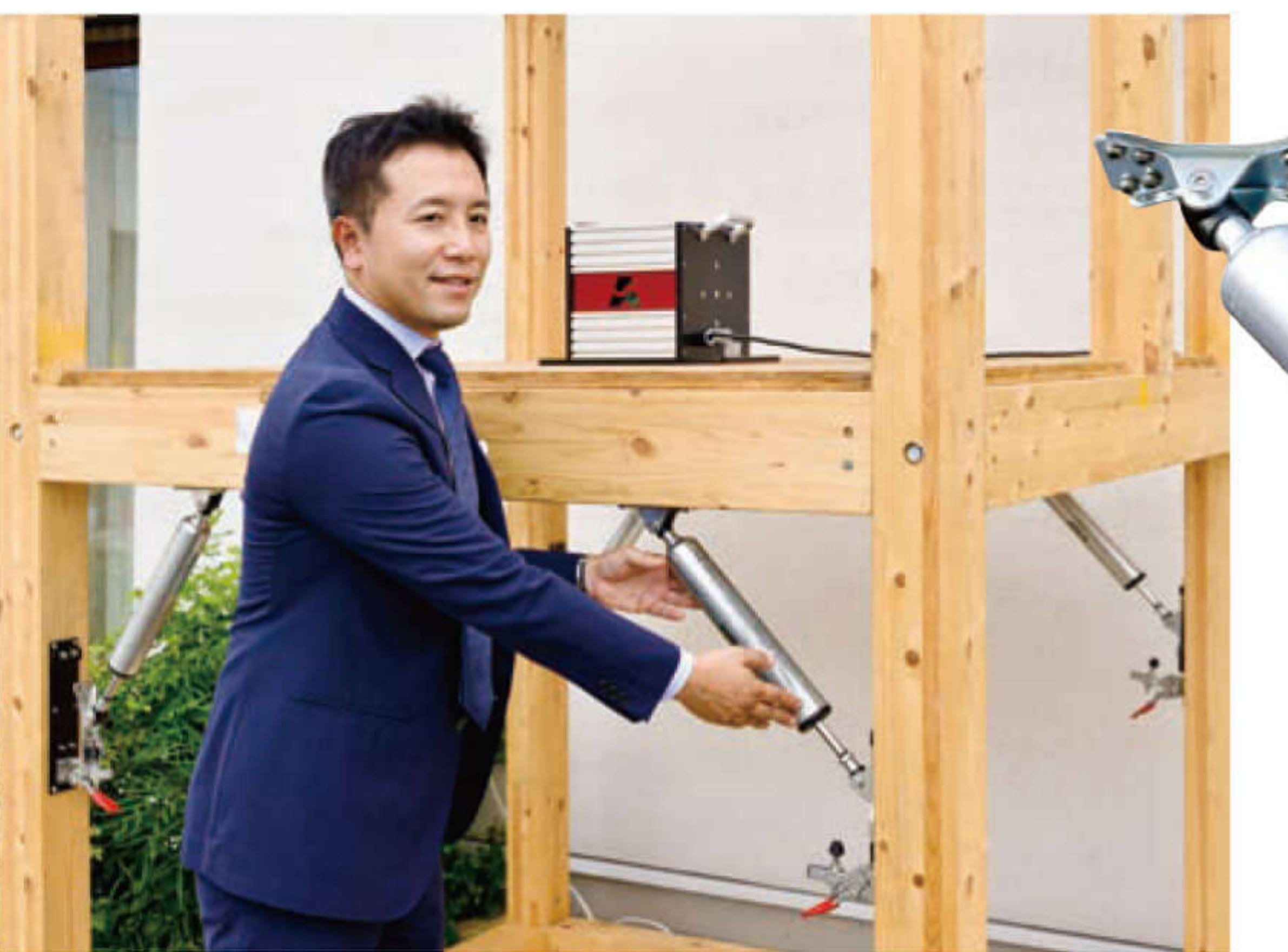
制振体験装置に取り付けられた「evoltz」を手にする千博産業・渥美社長。耐震性能と「evoltz」の制振性能で衝撃は約2分の1に
