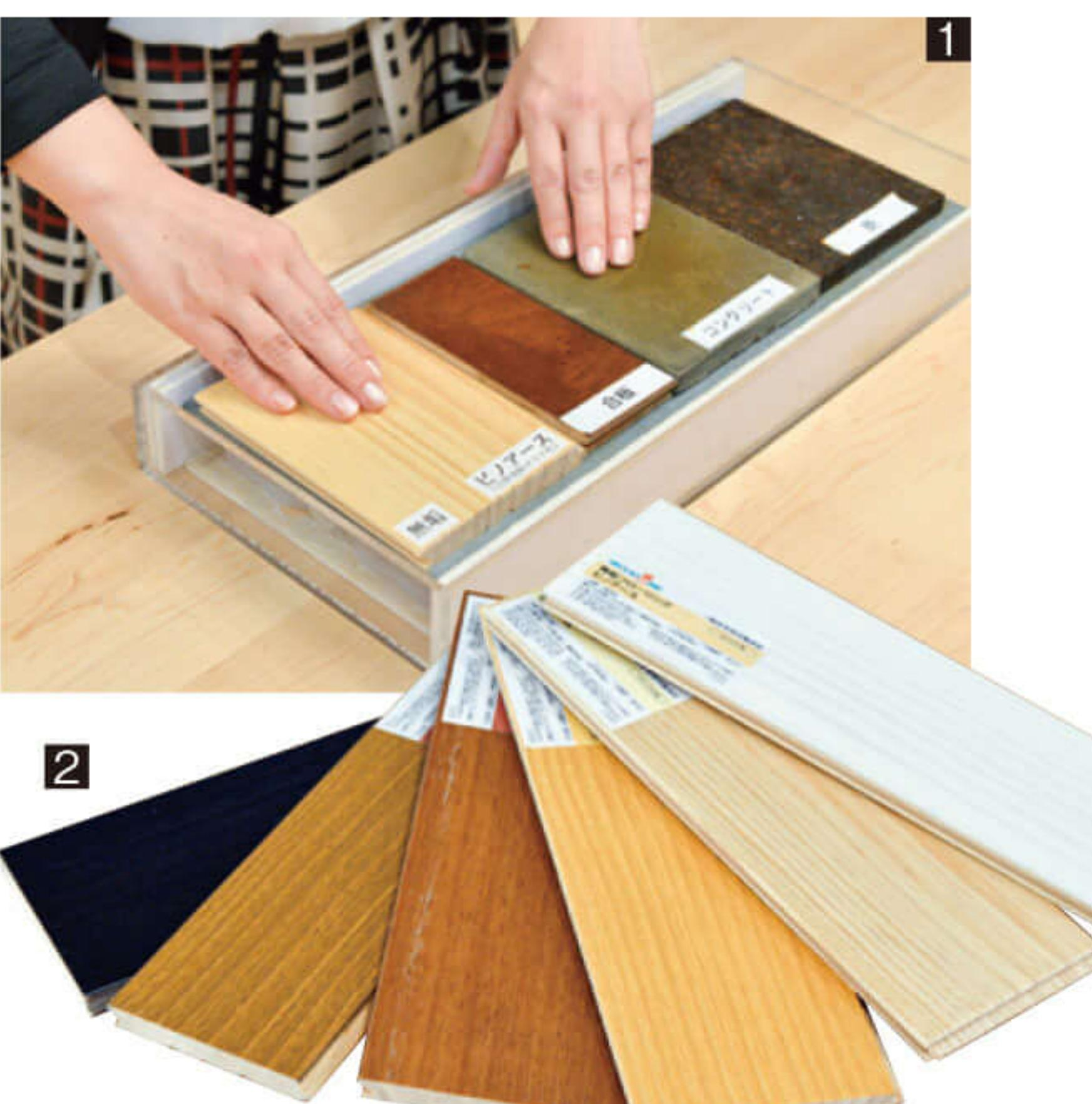
①素材別の熱伝導率の比較実験。保冷材の上に鉄、コンクリート、合板、無垢材の4つの素材が並んでおり、触って比べると、無垢が一番冷たく、逆に鉄が一番ひやっとする。②無垢フローリングのサンプル。同じバイインの無垢材でも仕上げの違いによって色が異なる。
