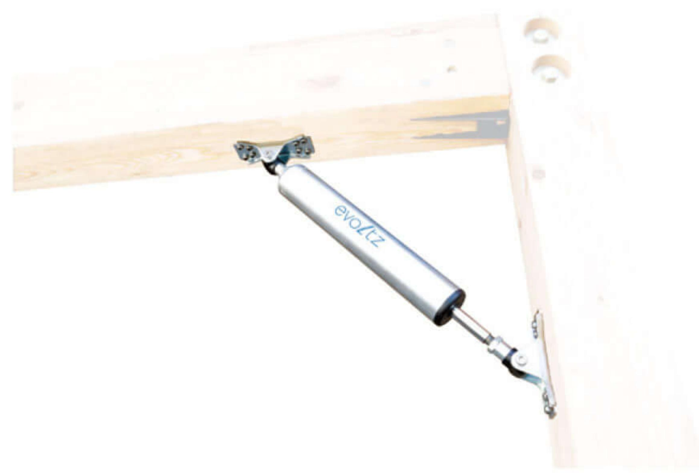
アルネットホームで採用している制振ダンパー「evoltz（エヴォルツ）」。梁と柱に固定するように取り付け、揺れ始めから力を発揮し繰り返す余震にも性能は衰えない
